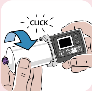
Draai de cassette dan om hem aan de pomp vast te maken.
